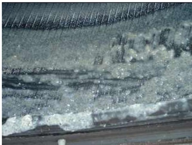
El mayor daño que produce el LATEX es que aumenta fuertemente la temperatura del neumático, que es lo que más daño produce, ya que esto, en el corto plazo, hace que los componentes del producto se separen, dejando completamente desprotegido muchas zonas internas del neumático. El LATEX deja el neumático más blando y expuesto a mayores daños, desde laceraciones, hasta punciones.
