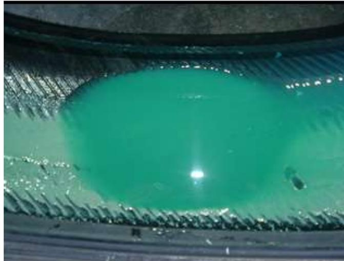
En este caso se separa el líquido del producto en sí y se decanta, lo que no ayuda en el sellado y aumenta el riesgo de desbalanceo. Se observa que quedan restos de agua, lo cual es un ACELERADOR de oxidación de las telas de los neumáticos y las llantas.
