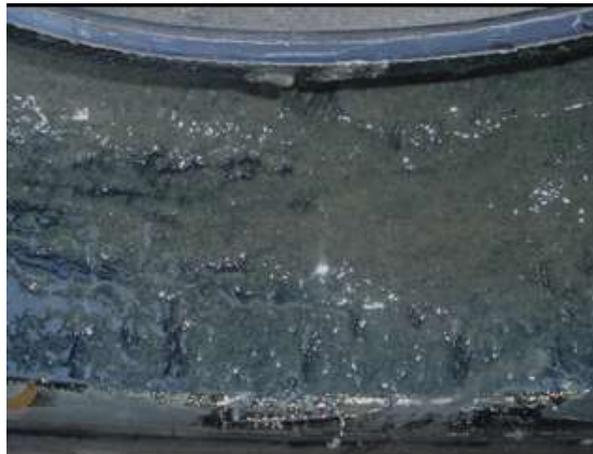
En este caso el producto no cubre integralmente la superficie interna del neumático, generando grumos focalizadas de producto generando problemas de balanceo, además es visible que carecen de partículas de caucho, que si tuvieran, es parte de lo que asegura el sellado del canal al ser perforado.
